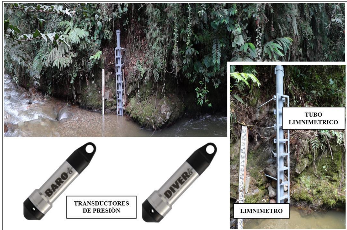
Figura 4. Estación automática de niveles El Rasgón
